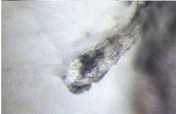
・高台と焼結粘土の隙間にガラス化したモミガラが熔着。
