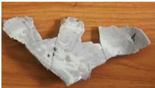
・高台と焼結粘土の隙間にガラス化したモミガラが熔着。
