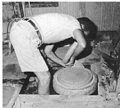
甕底に粘土棒をひねり付ける
